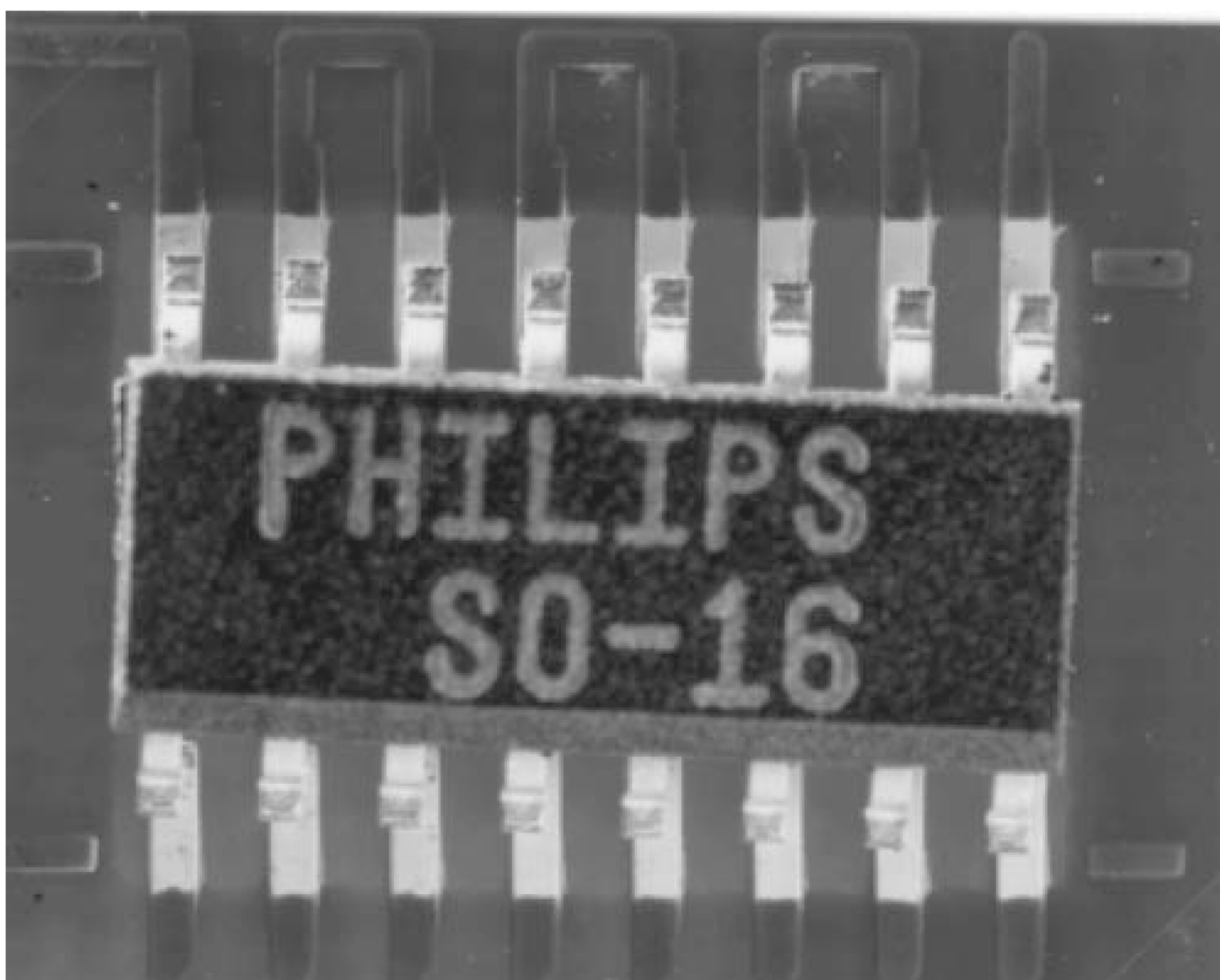
Рисунок 12 — Установка корпусов микросхем с выводами в виде крыла чайки на две стороны: заданное состояние
