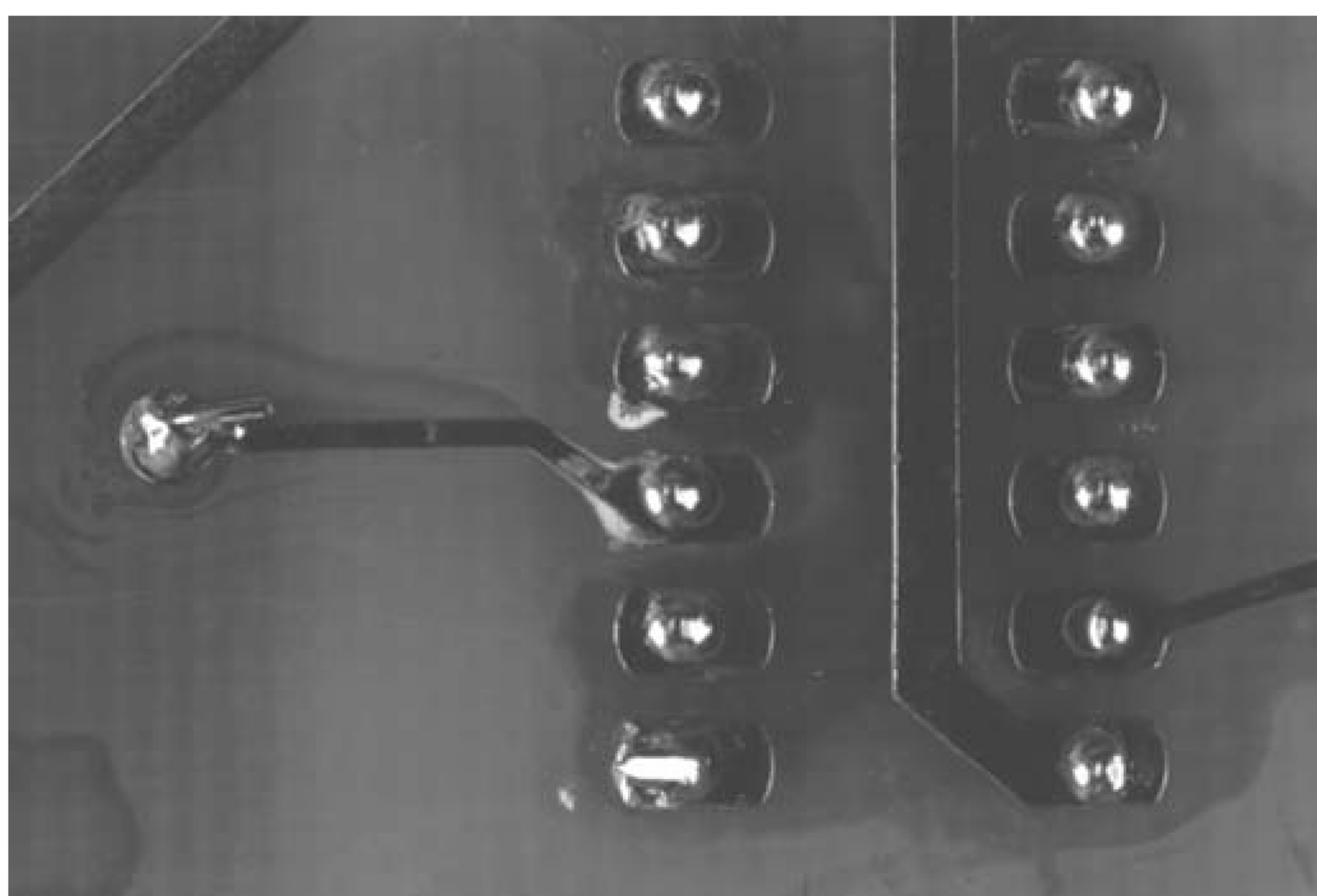
Рисунок 81 — Белесые остатки: недопустимое состояние
