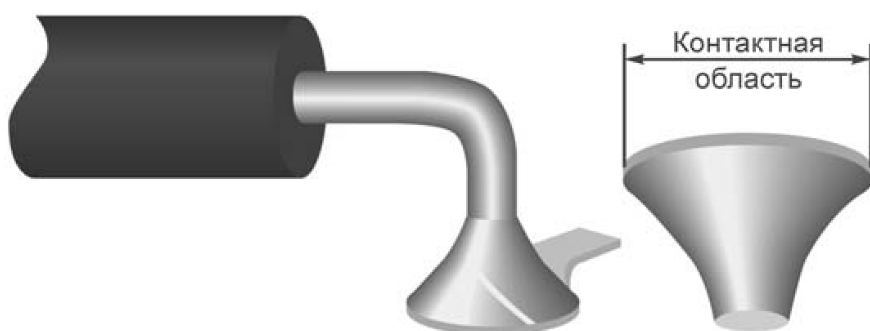
Рисунок 65 — Галтель припоя: заданное состояние
