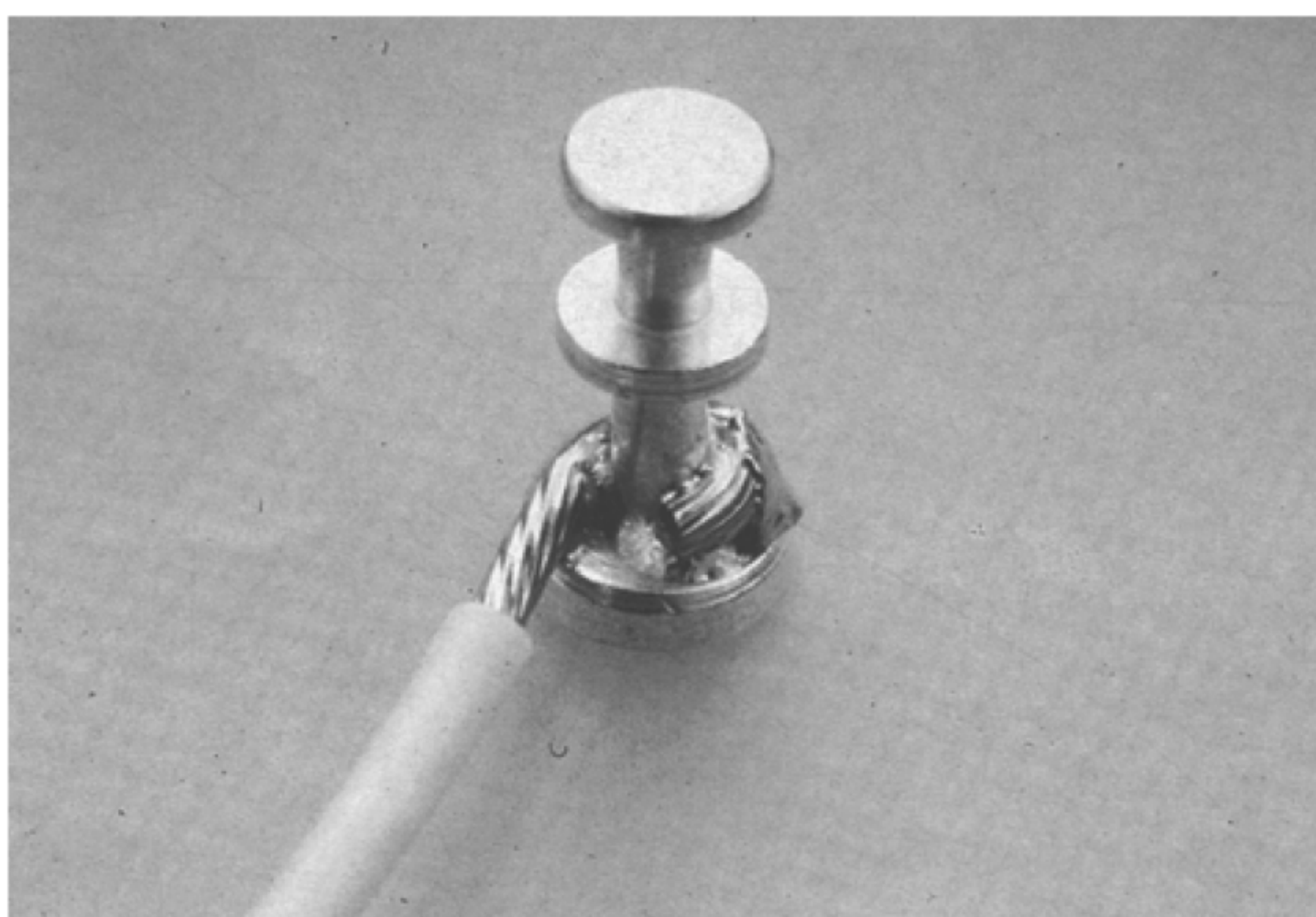
Рисунок 36 — Паяное соединение провода с контактом: недопустимое состояние
