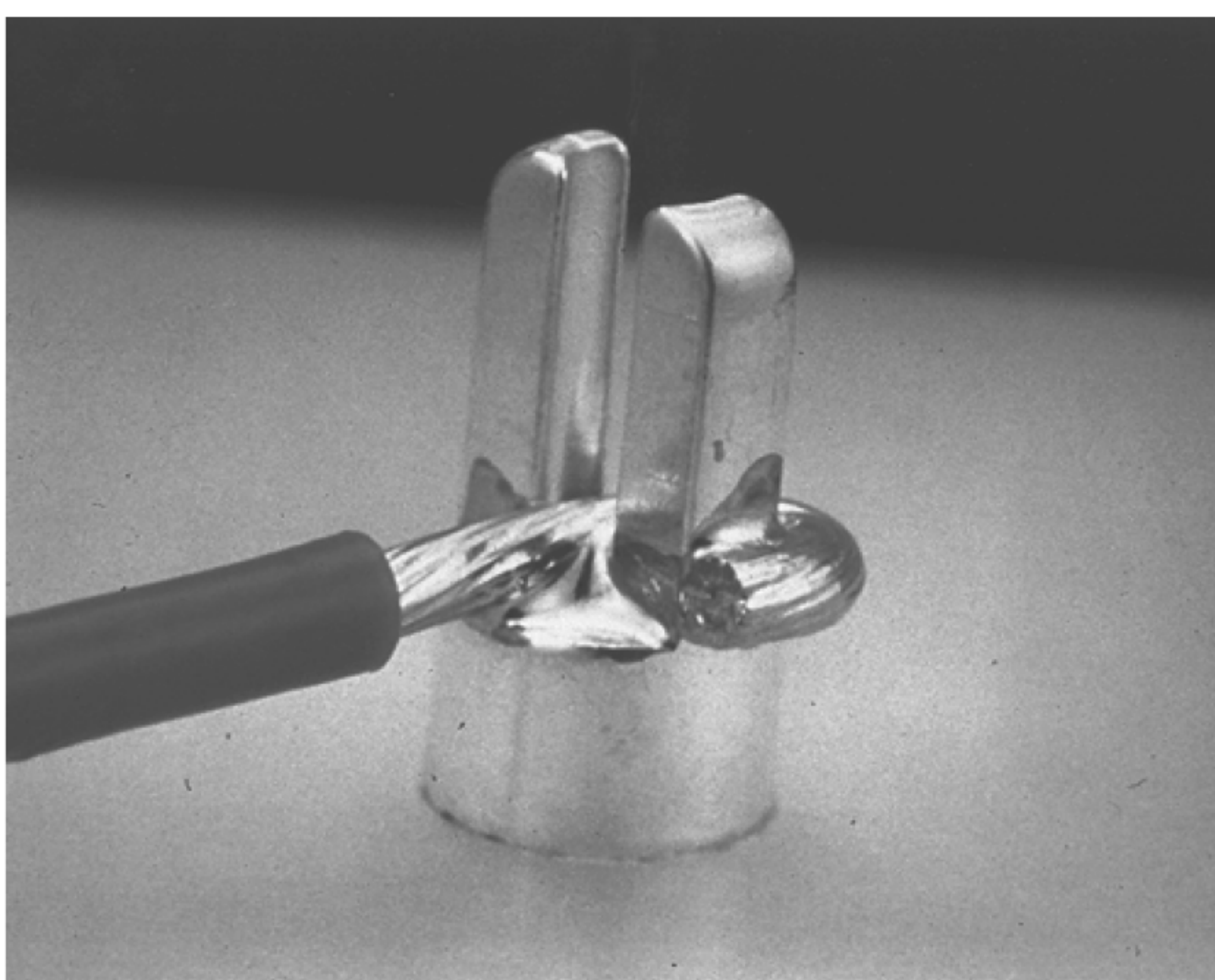
Рисунок 34 — Паяное соединение провода с контактом: допустимое состояние
